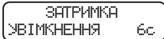
Показує, через скільки секунд після запуску (включення вхідного автомата) стабілізатор подасть напругу на вихід.
