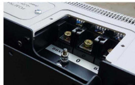
5. Зачистить, оборудовать наконечником провод защитного заземления и закрепить его гайкой на винте рядом с клеммником в отсеке клеммника.
