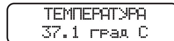
Температура основных элементов прибора, в градусах Цельсия (°C). Максимальная температура может составлять не более 80 градусов, в противном случае устройство отключится.
