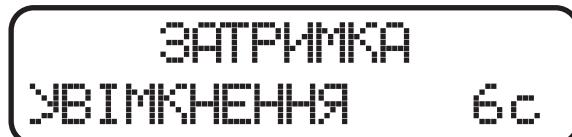
Показує, через скільки секунд після запуску (включення вхідного автомата) стабілізатор подасть напругу на вихід.
