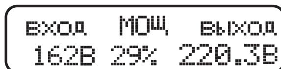
Высвечивается после тройного нажатия на кнопку «Вправо». Слева направо: входное напряжение, в Вольтах; Процент загрузки, от максимально возможной мощности при данном входном напряжении; Выходное напряжение, в Вольтах и десятых долях Вольта.
