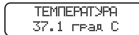
Температура основных элементов прибора, в градусах Цельсия (°С). Максимальная температура может составлять не более 80 градусов, в противном случае устройство отключится.
