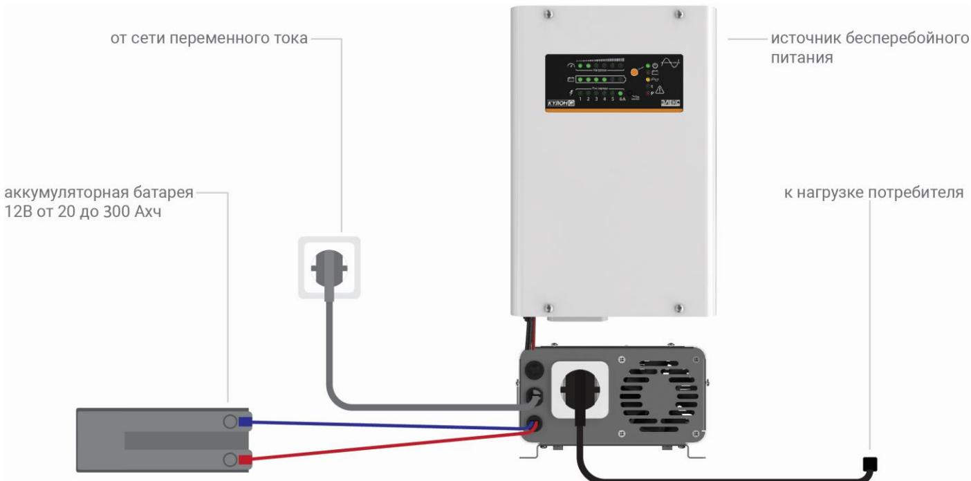
Рисунок 6. Схема подключения ИБП
