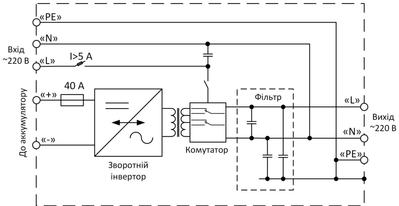
Рисунок 4. Блок-схема ДБЖ КУЛОН при роботі від батареї
