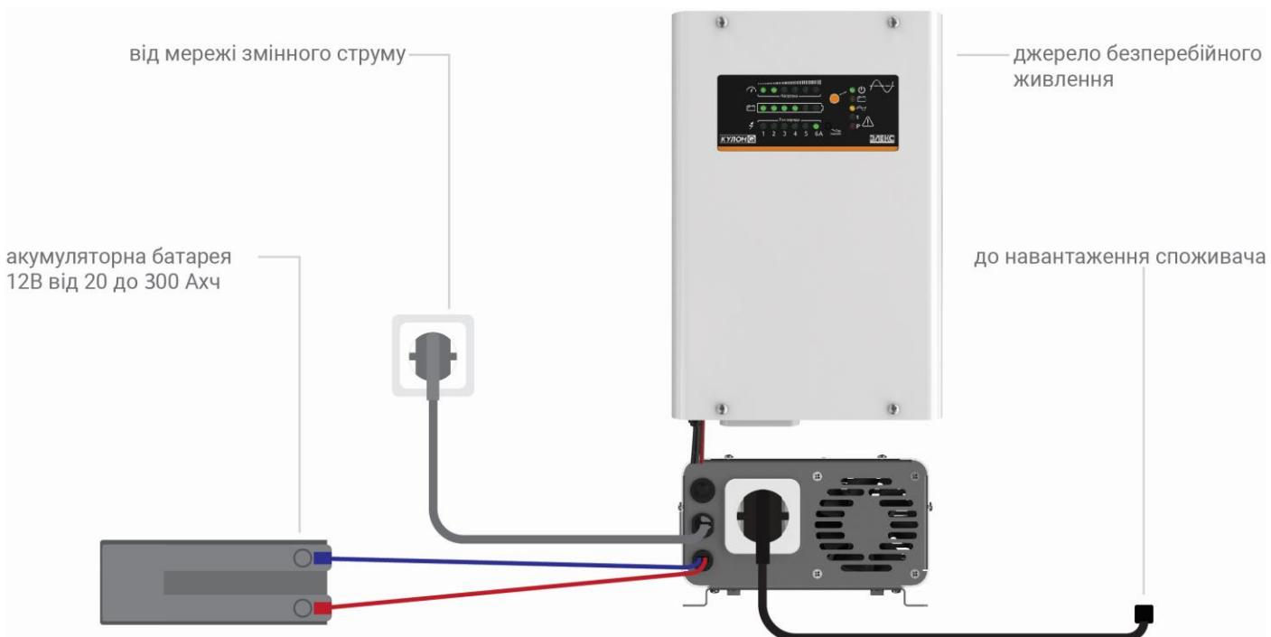
Рисунок 6. Схема підключення ДБЖ до силової мережі
