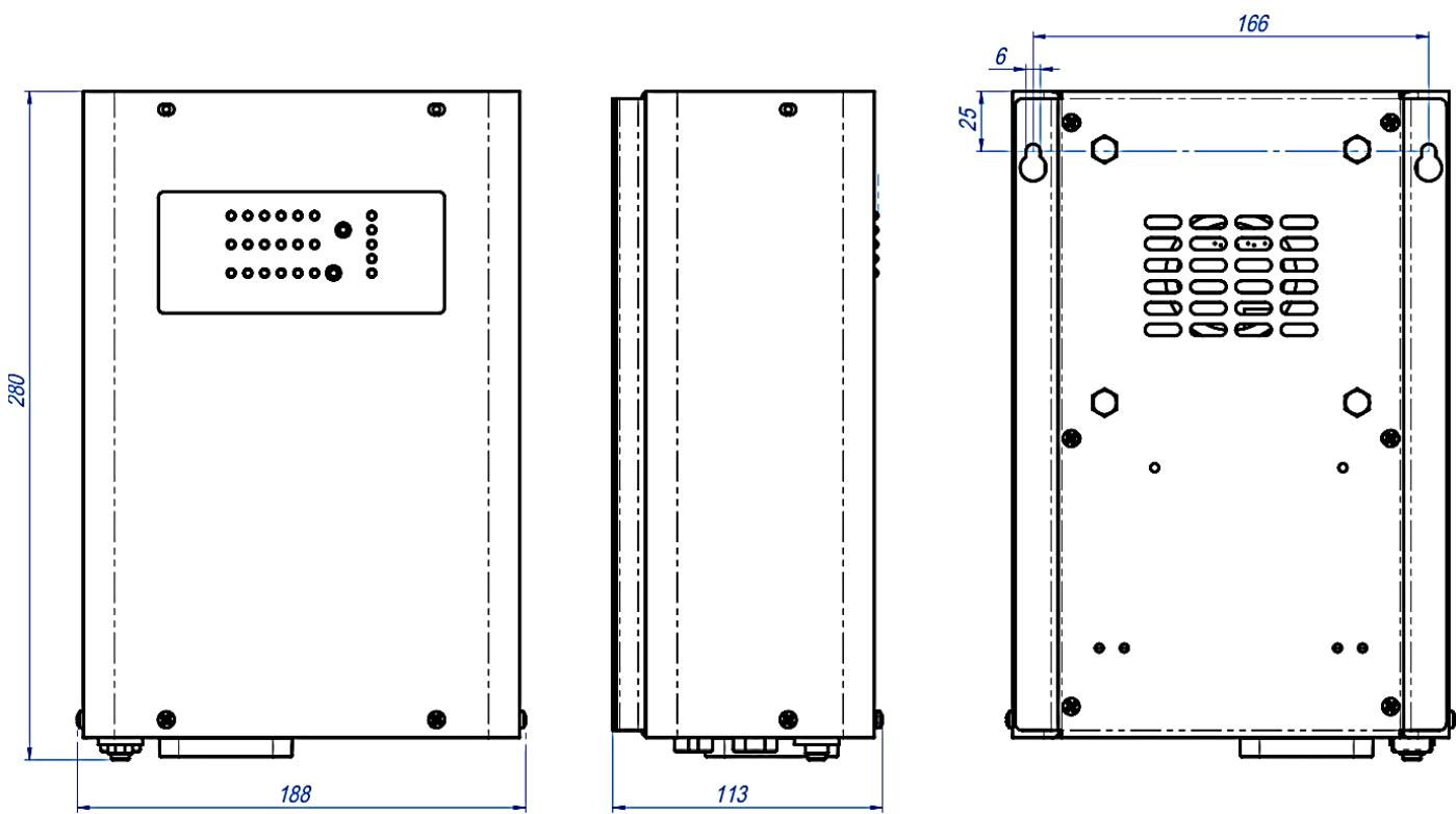
Рисунок 5. Установочные и посадочные размеры ИБП
