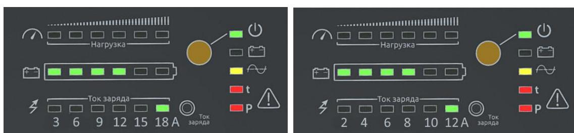
Рисунок 2. Внешний вид панели индикации ИБП на 300 и 180ВА
