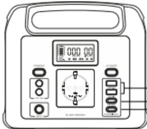
Коли два порти USB-A використовуються одночасно, їх вихідні параметри становитимуть 5 В / 3.8 А загалом.
