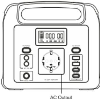
A. Вставте кабель живлення пристрою змінного струму в розетку на корпусі приладу. Натисніть кнопку AC для запуску режиму змінного струму (AC).
